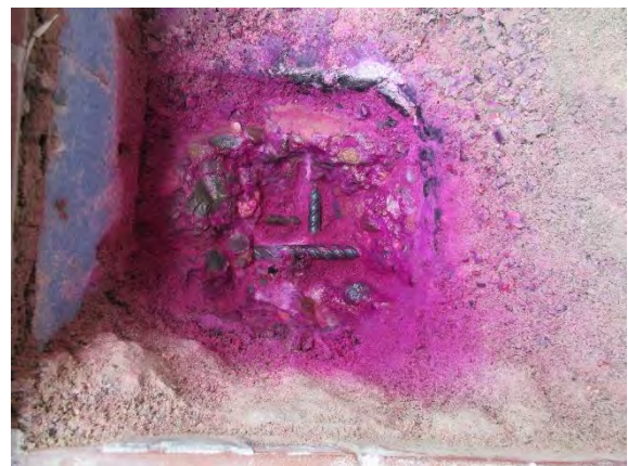
Abbildung 2-14: Sondierfenster Balkonboden mit aufgesprühtem Indikator
