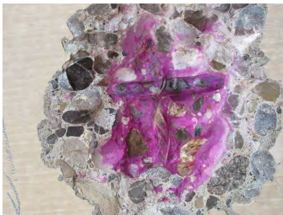
Abbildung 2-13: Sondierfenster Balkondecke mit aufgesprühtem Indikator
