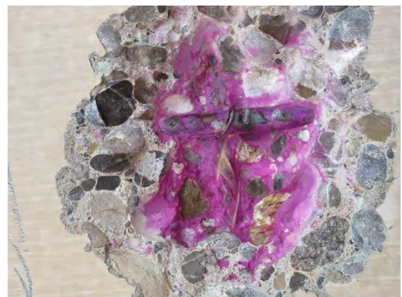
Abbildung 2-24: Sondierfenster 2; Balkondecke
